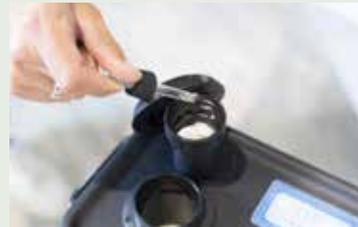
bouchon de remplissage d'eau
